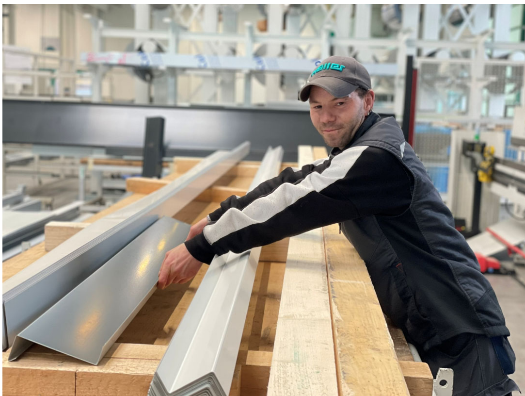
Alexander Schwer bearbeitet Metallteile, aus denen später Verkleidungen für öffentliche Gebäude, Messehallen oder Industriegebäude entstehen. (Foto: Niggemann)
